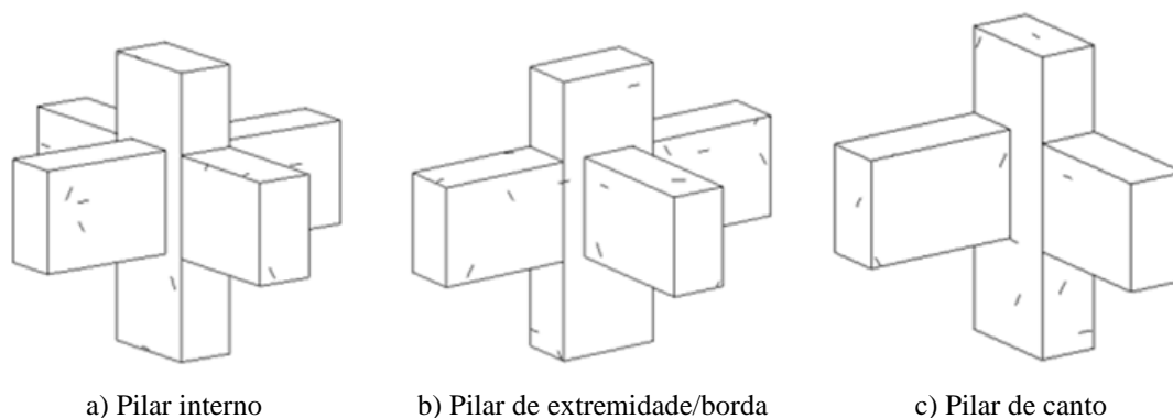
Figura 1.1. Classificação dos pilares em uma edificação.
